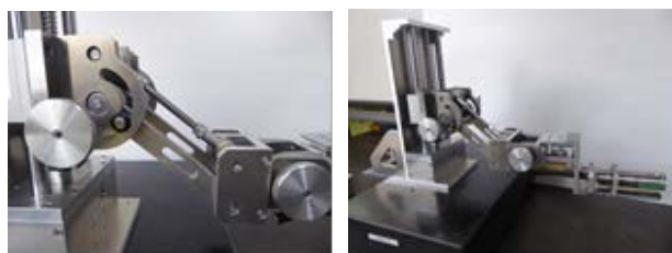
図 16 管球取り付けアーム
