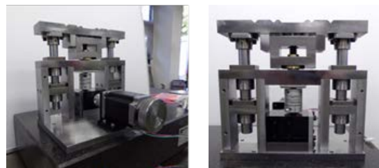
図 14 製作した 4 点曲げ試験装置
