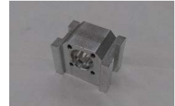
図20 ハウジング機で加工を行った形状ブロックの完成品
