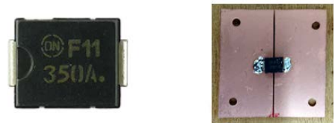
図 7 定電流ダイオードと設置基板
