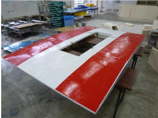
図6 完成したアッパーボディー
