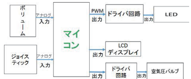
図 6 コントローラのシステム構成図
