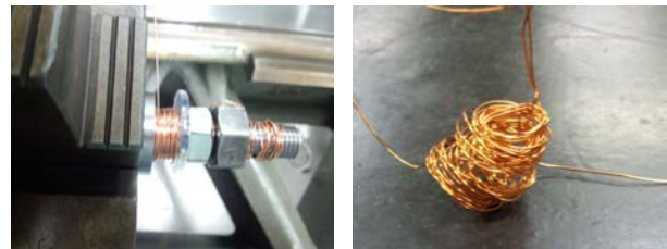
(a)治具による作業 (b)失敗例
