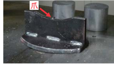
図 18 ローラー部の爪
