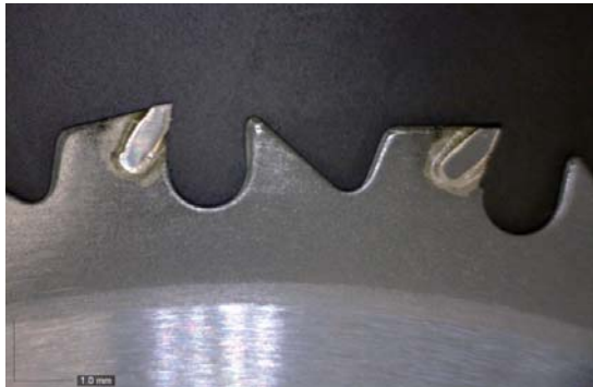
図 12 キックバック対策竹専用チップソー(日光製作所)
