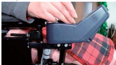
図 27 送信デバイスを電動車椅子に追加装着する
