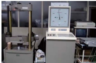
図 17 油圧サーボ式万能試験機
