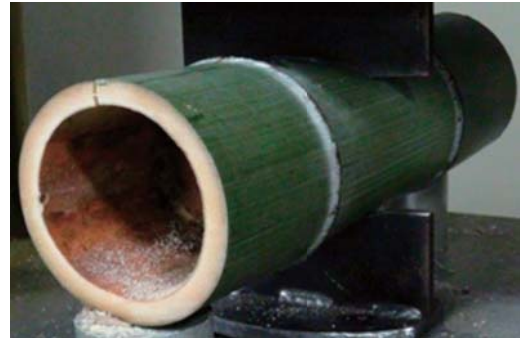
図 19 実験に使用した竹サンプル(破断時直後の写真)
