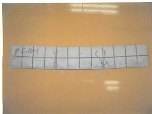
写真2 主筋φ6（フック付き、あばら筋間隔100mm）における破壊性状
