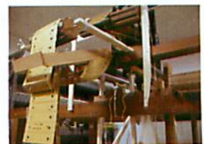
図12 ジャカード装置
