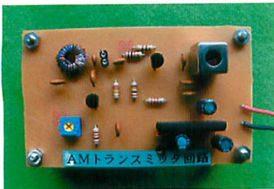
図7 AMトランスミッタ回路
