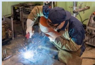
被覆アーク溶接
