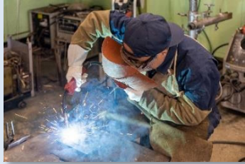
被覆アーク溶接
