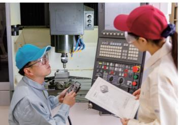
「もの」の良し悪しが決まる重要な工程が「加工」です。機械の特性を知り尽くし、また金属材料の性質を理解した上で加工する必要があり、0.001mmの寸法のずれが品質に大きく影響します。訓練を通じて精密部品加工技術を習得します。
