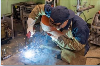
被覆アーク溶接
