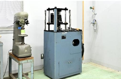
**継手曲げ試験機**
