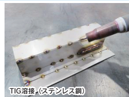
TIG溶接（ステンレス鋼）
