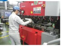
機械を使って薄板を曲げる作業です。図面から材料準備、原寸作成、組立、溶接の一連の流れを学びます。
