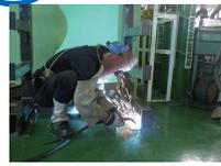
半自動溶接ともいわれ、最も多く使用されている溶接方法です。溶接作業の知識と技能を習得します。
