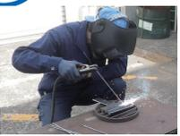
建物や設備の溶接施工などで使われている被覆アーク溶接作業の知識と技能を習得します。
