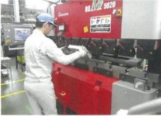
機械を使って薄板を曲げる作業です。図面から材料準備、原寸作成、組立、溶接の一連の流れを学びます。
