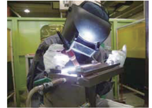
【治具を用いた下向き突合せ溶接】
