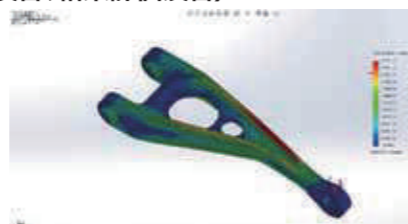
【構造解析結果(フォン・ミーゼス応力)例】
