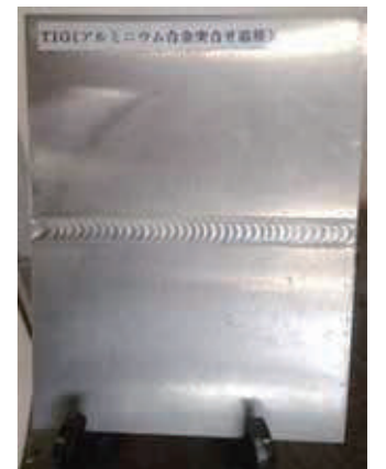
[薄板突合せ下向き溶接]
