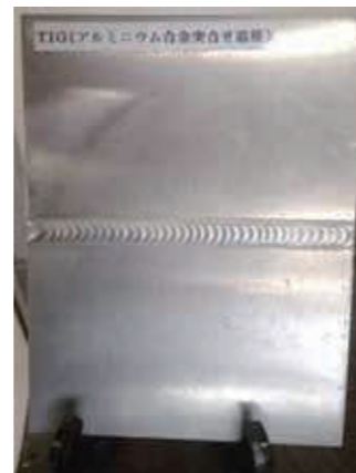
[薄板突合せ下向き溶接]
