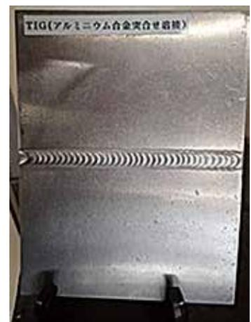
[薄板突合せ下向き溶接]
