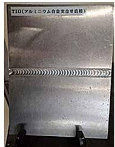
【薄板突合せ下向き溶接】
