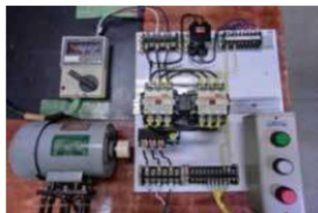
〔有接点制御実習機材 （正逆運転回路）〕
