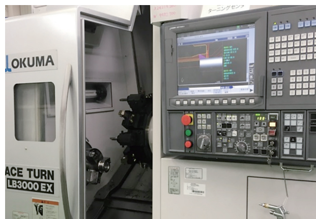
NC旋盤：オークマ社製LB3000EX NC装置：OSP-P200LA
