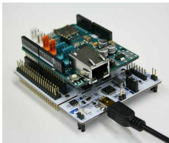
使用するターゲットマイコンに Ethernetボードを搭載した様子
