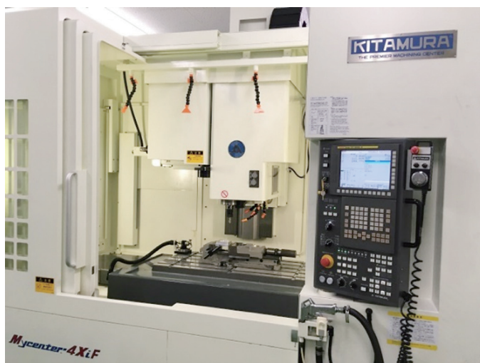
マシニングセンタ：キタムラ機械社製 Mycenter-4XiF NC装置：FANUC Series 30i-MODEL B
