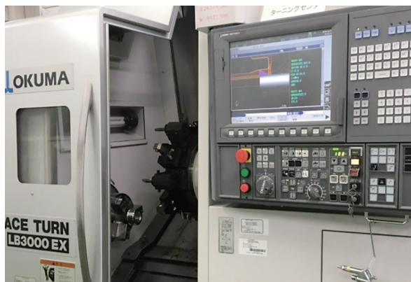
NC旋盤：オークマ社製LB3000EX NC装置：OSP-P200LA
