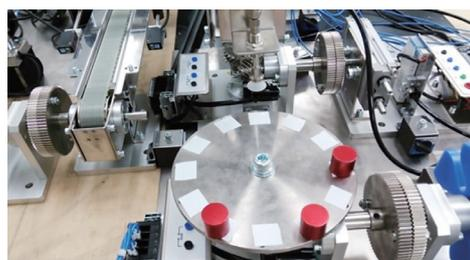
(近接センサ検知による排出機構)
