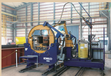
保有機器 （鉄骨柱大組立溶接ロボットシステム）
