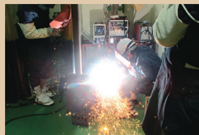
セミナー受講風景 （溶接部の補修に関わるガウジング実習）
