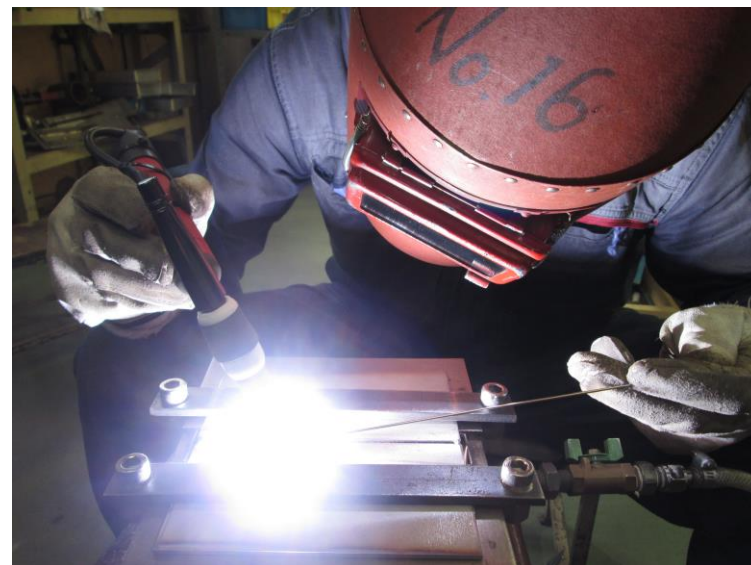
溶接ものづくり科の実習（TIG溶接）の様子
