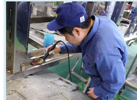
ステンレス製品のサンダーや仕上げ作業を任せています。どうしたらきれいに仕上がるかを常に考え、試しながら進めています。
