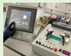
「PLC制御」とは、パソコンのソフトウェアを使ったプログラミングによる制御手法です。有接点シーケンス制御と比較して、複雑な制御が可能であり、動作の変更も柔軟に行える特徴があります。
