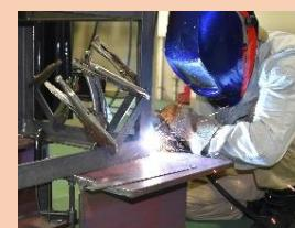
工作機械による加工と溶接による接合を組み合わせた課題を通して、機械の安全な使用方法や目的の精度を満たす製作手順を学びます。
