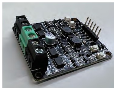
図 7 モータドライバ (MDD3A)
