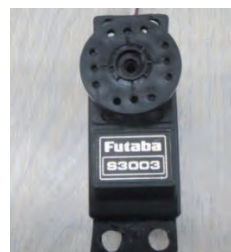
図 4 使用したサーボモータ（S3003）
