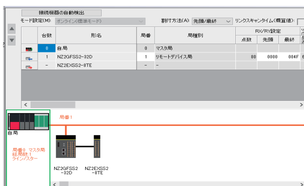
図5 本実習機の安全ネットワークの構成
