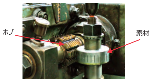
図4 ホブ盤(日本機械製作所製 NJ-300)による 歯車加工中の様子
