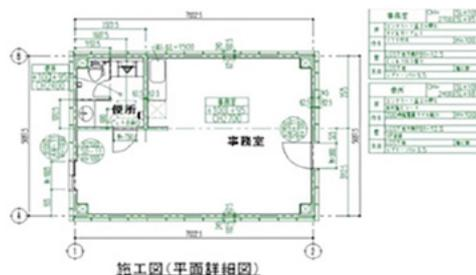
施工図(平面詳細図)
