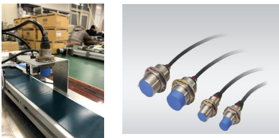
図6 材質判別方法と使用近接スイッチ
