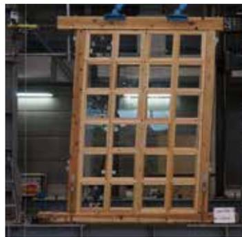
強化ガラスを用いた補強壁の
