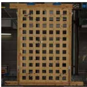
面格子壁の水平加力実験
