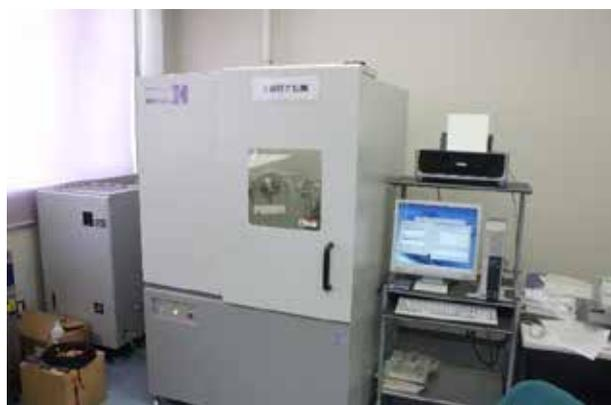
図1 X線回折装置 (XRD)
