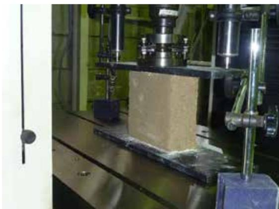
図 1 壁土の圧縮強度試験
