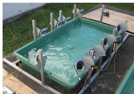
制御方法としては、マイクロコンピュータを用いフィードフォワード制御を行っている。具体的には、ネットワークを利用し数時間後の気象（天候、気温、湿度等）を把握することにより、温度上昇を予測し水温が上昇する前に対応している。
