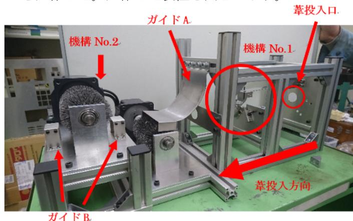
図1 皮むき実験装置
