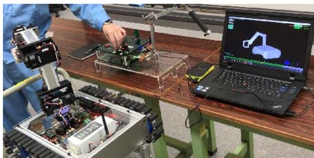
図2 ロボットエミュレータによる評価実験
