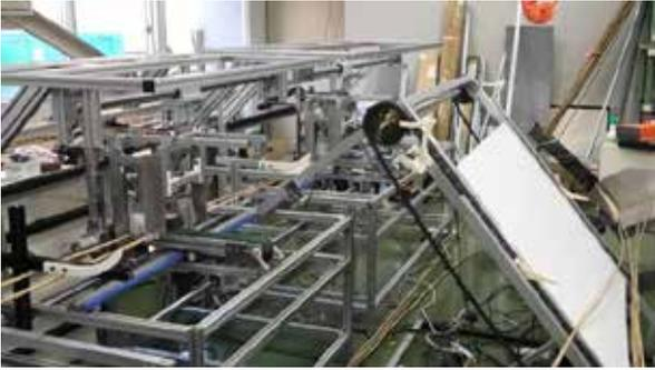
写真 開発したよし皮むき装置
