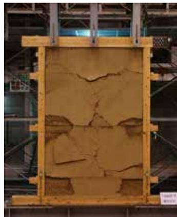
図 2 真壁の試験後の破壊形状
