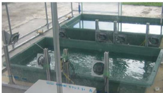
養殖水槽の水温データ収集実験
