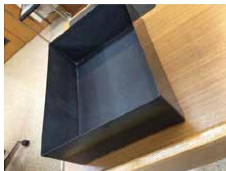
図1 炭素繊維強化プラスチックによる試作筐体
