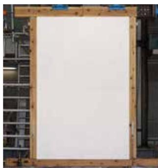
構造用合板を用いた修復壁の実験
