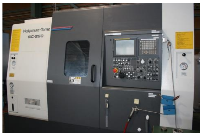
使用機器：NC旋盤 中村留精密工業(株) SC-250 制御装置：FANUC
