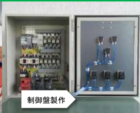
シーケンス制御(PLC)
