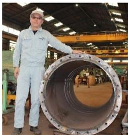
直径1m×長さ5mの型枠
