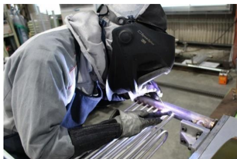
TIG溶接で細径パイプを溶接中
