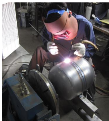
TIG溶接でステンレスタンを溶接中
