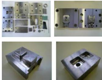
プラスチック射出成型金型の製作
