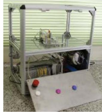
全自動遊具の設計・製作～ハノイの塔の自動化～
