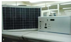
避難所運営システム災害時運用のための太陽光蓄電システムの開発
