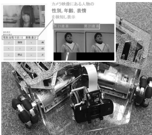
図5 全方向移動ロボット[平成28年度]
