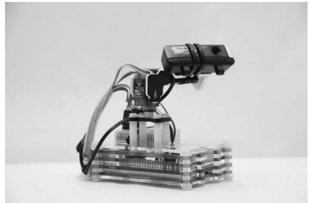
図9 全方向移動ロボットプロトタイプ [ARゴーグルの首振りと連動するモータ付カメラ]
