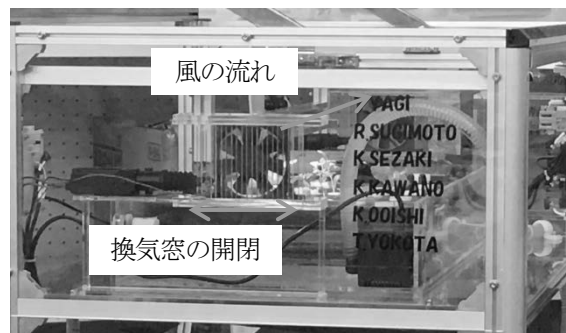
図11 自動換気(換気窓)
