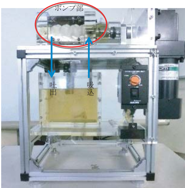
図5 製作した偏心ねじポンプ
