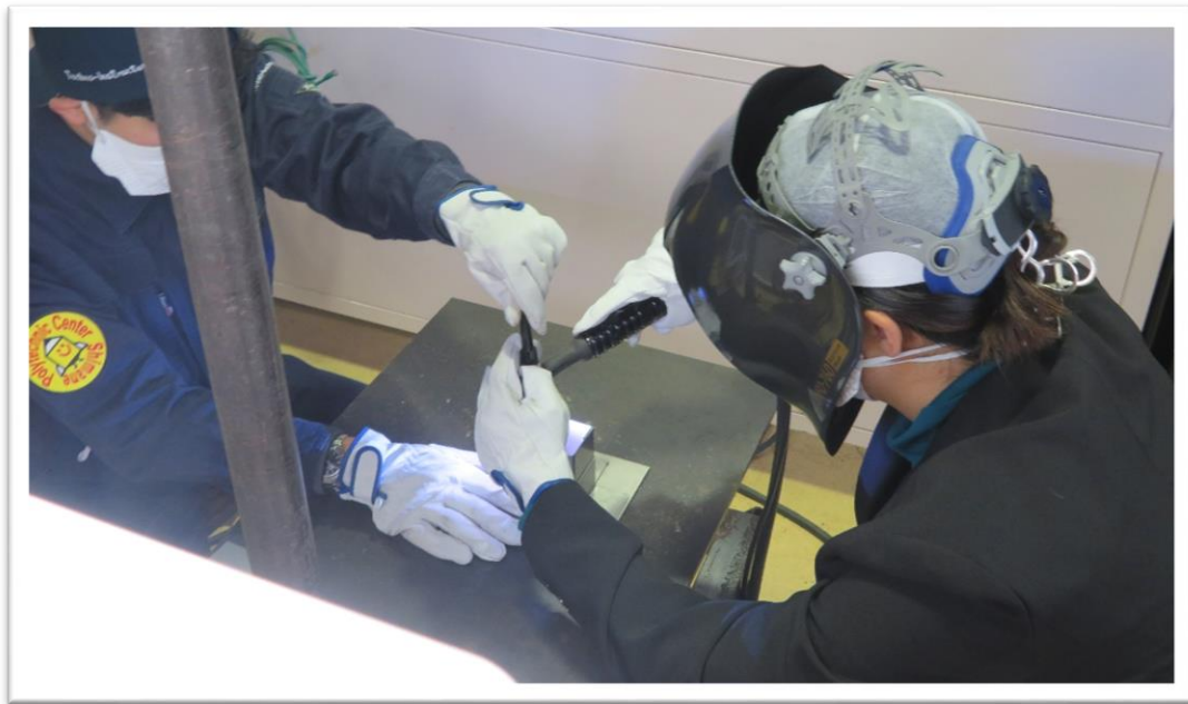
溶接体験では、TIG(Tungsten Inert Gas:ティグ)溶接を体験いただきました。
