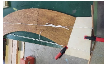
図20 治具と紐による圧着
