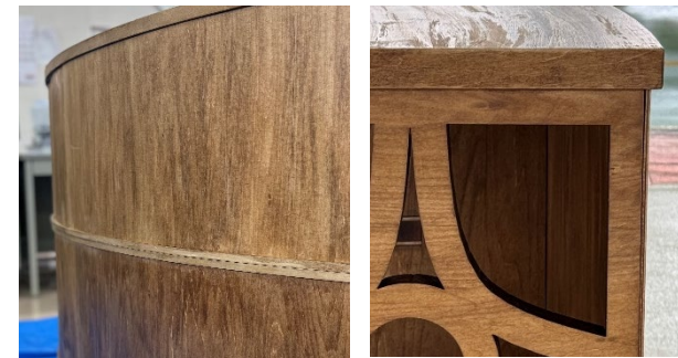
図15 改善した背板の取付と天板勝ちの仕上げ
