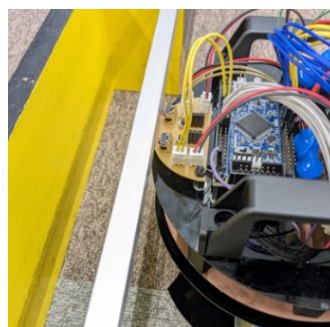
図9 スイッチによるゴールポストの検出
