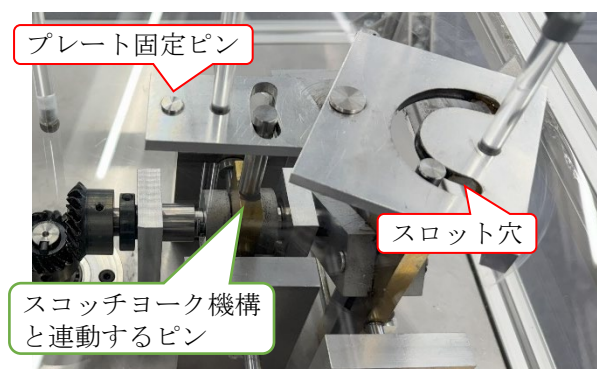
図 14 揺動運動に変換するプレート
