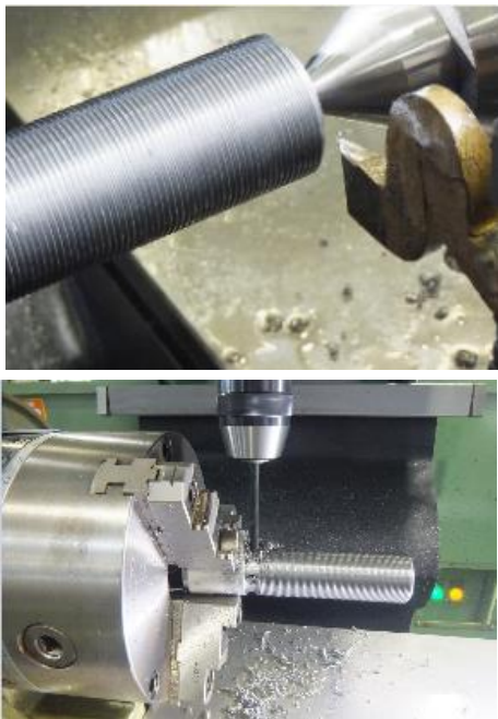
図4 高さ調節ねじの加工
