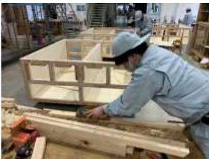
図 18-11 仕上げ削り
