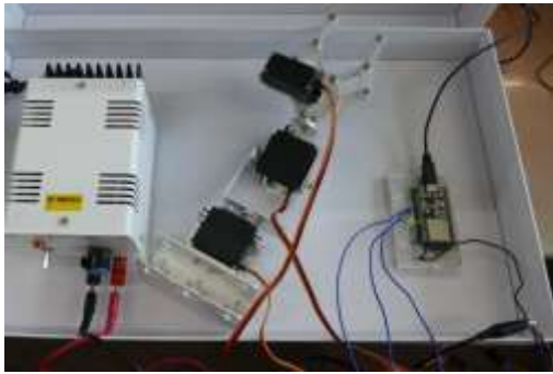
図 15 実際の ESP32 とハードウェア配線
