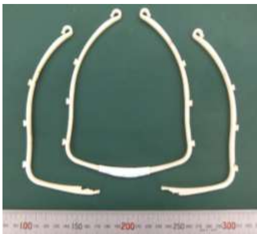
図 5 製作したフェイスシールドフレーム
