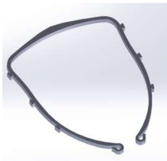
図 2 設計したフェイスシールドフレーム
