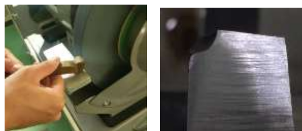
図4 球形状加工用の自作総形バイト
